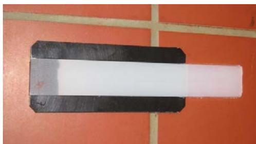
In Abb. 2 sind die Glc-Werte in Abhängigkeit von der Vorbehandlung der Hartkomponente PPS graphisch dargestellt. Im optimierten PPS/TPU-Verbund, d. h. Verbundbildung mit Plasmabehandlung und reaktiver Adhäsionsschicht, wird ein Glc-Wert von ca. 12 N/mm erreicht.
