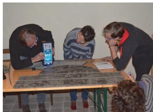
Abb. 3: Vor-Ort-Messung am ausgebautem Fenster mit Handheld Raman-Spektrometer
