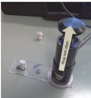
Abb. 5: Bestimmung der Schichthaftung von Polymerfilmen auf Glas
