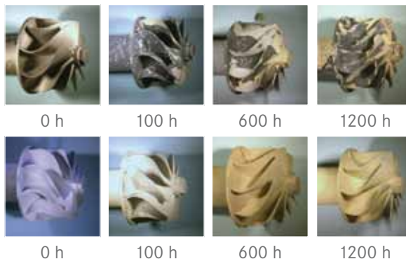
Turbolader-Rotor-Oxydation: unimplantiert und F-implantiert
