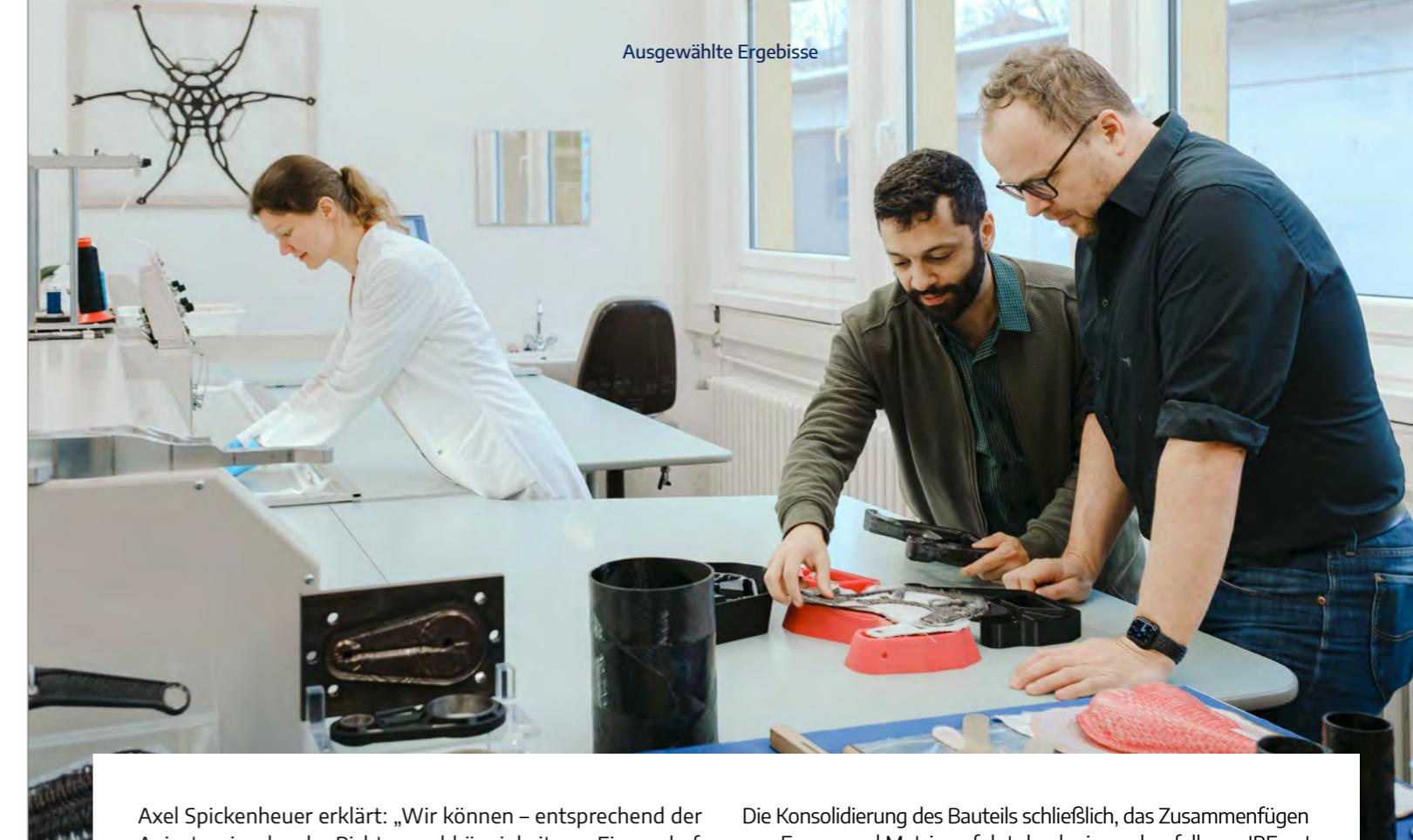
Axel Spickenheuer erklärt: „Wir können – entsprechend der Anisotropie, also der Richtungsabhängigkeit von Eigenschaften – durch eine zielgerichtete Faserorientierung die Kennwerte des Verbundbauteils speziell anpassen.“
