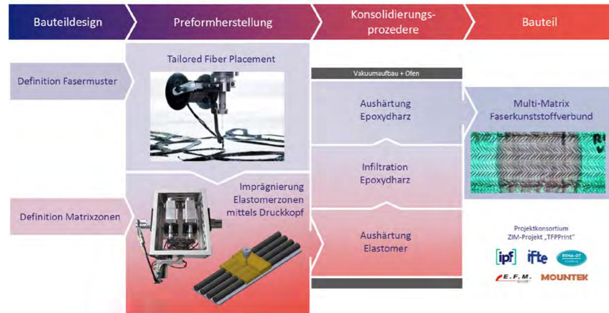
Abb. 1 Verfahrensablauf der im ZIM-Projekt „TFPprint“ entwickelten Technologie.
