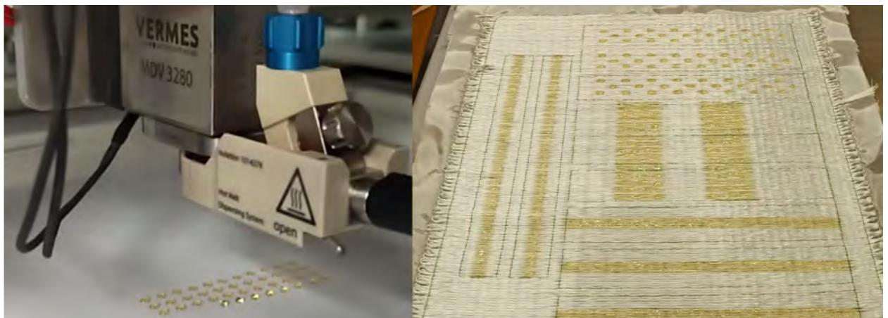
Abb. 2 Links: Tropfenabgabe durch den Elastomerdruckkopf (zur besseren Sichtbarkeit auf Papier). Rechts: Mit der Anlage partiell mit PU imprägnierte Glasfaser-Preformen.
