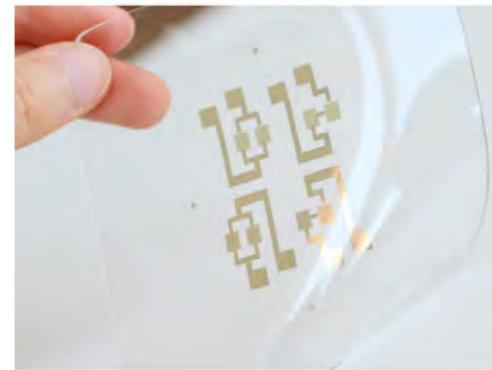
Abb. 2 Hergestellte Sandwichschicht aus Metalldünnschichten mit einer weichen Sperrschiicht dazwischen – Grundprinzip für dehbare mechanosensitive elektrische Komponenten zur Herstellung von Dünnschicht-Logikschaltungen.
