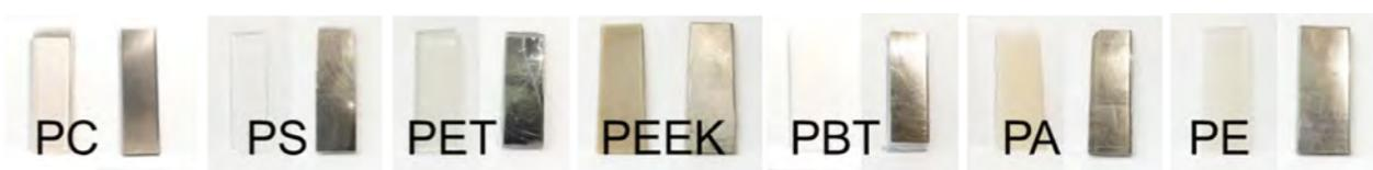
Abb. 2 Funktionsprototypen jeweils unbeschichtet und metallisiert.
