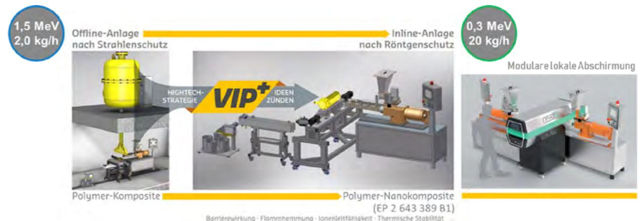
Abb. 2 Entwicklung einer modularen kontinuierlichen elektroneninduzierten reaktiven Aufbereitung
