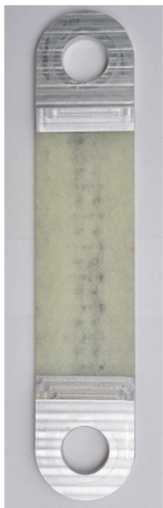
Abb. 5: Am IPF durch Pressen hergestelltes TPP-Segment einer Koppelscheibe mit metallischen Inserts
