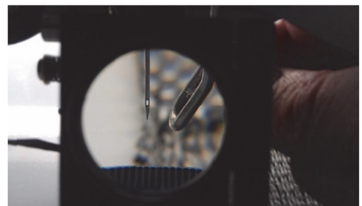
Abb. 4: TPP-Prozess mit Prepreg-Roving auf der Anlage der Dietrich Wetzel KG - Nadel nach ca. 14.000 Stichen – keine Matrixdepositionen sichtbar
