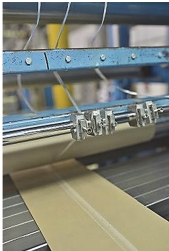
Abb. 2: Herstellung eines Prepreg-Glasfaserrovings auf der Versuchsanlage zur Rovingimprägnierung beim Projektpartner IFC Composite GmbH
