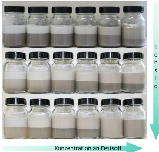
Ölschlammmodell aus 20 % Öl (Kerosin) in 80 % Wasser mit Tensid als Tensid (1; 10; 20 g/L) und dem Ton-Mineral Blauton (5 - 125 g/L) als Feststoffanteil nach einem Monat Standzeit.
