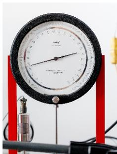
GNOMIX PVT Apparatur (GNOMIX Inc., USA) zur Bestimmung von Änderungen des spezifischen Volumens von Feststoffen und Flüssigkeiten in Abhängigkeit von Druck (0,1 MPa bis 200 MPa), Temperatur (RT – 400 °C) und Zeit ( $t \rightarrow \infty$ )
