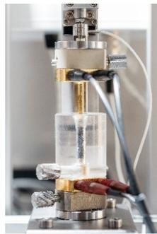
Pulverleitfähigkeitsmessstand (Eigenbau IPF) zur Messung der druckabhängigen elektrischen Leitfähigkeit von Pulvern und Pasten (Druck bis max. 30 MPa)
