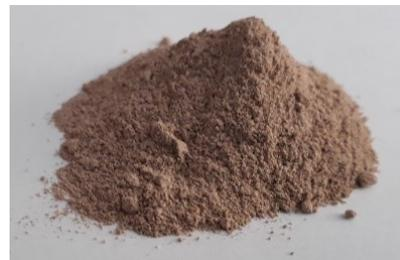
Biobasiertes Harz auf Basis von modifiziertem Lignin
