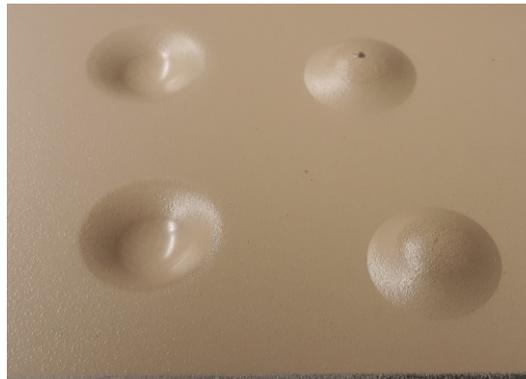
Pigmentiert und nach Impact/rev. Impact-Prüfung
