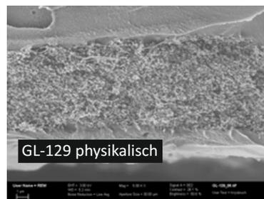
REM-Aufnahme der ausgehärteten Gleitlackschicht/ Kryoschnitt
