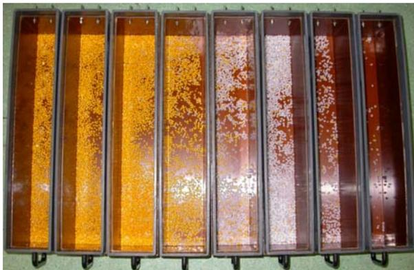
Abb. 5: Beispiel für die erfolgreiche Trennung eines Zweikomponentengemisches PP/PE (das PP-Granulat ist gelb, das PE-Granulat ist weiß) im Freifallscheider nach einem Vorbehandlungsschritt
