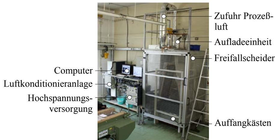
Abb. 1b: Gesamtansicht des elektrostatischen Freifallscheiders (Labor-Versuchsstand) zur triboelektrischen Aufladung von Kunststoffgranulatgemischen und deren Trennung im elektrischen Feld, Grundfläche ca. 4 x 4 m<sup>2</sup>.
