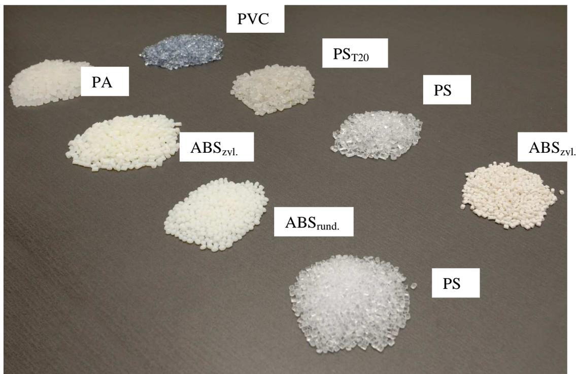
Abb. 61: Granulate der Kunststoffe PA6, PVC, ABS und PS
