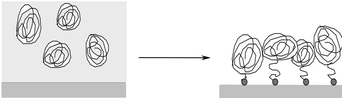
Bild 2: Adsorption von Makromolekülen aus einer Polymerlösung auf der Festkörperoberfläche
