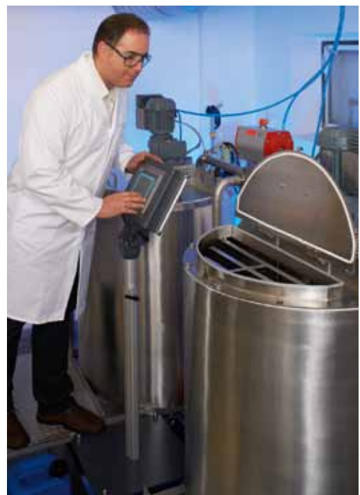
Großvolumige Reaktoren zur Synthese von PAO-PTFE-Schmierstoff
