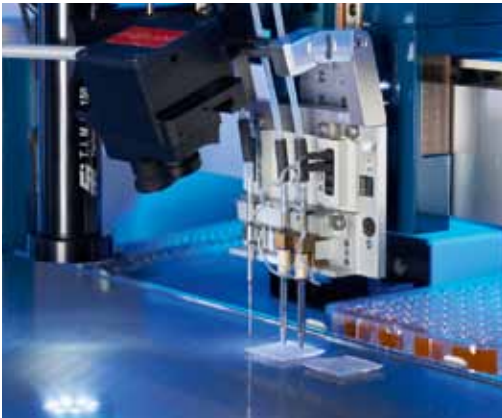
Drucken von Proteinmicroarrays in Silikonkavitäten für multiple Zellkulturexperimente
