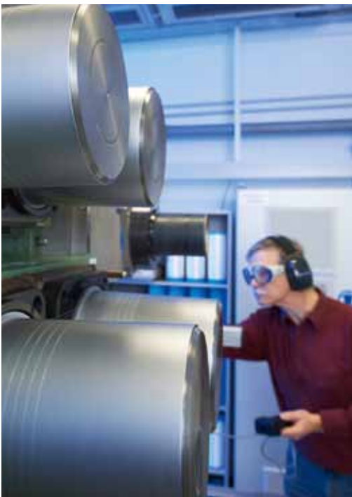
Schmelzspinnanlage für Polymerfäden
