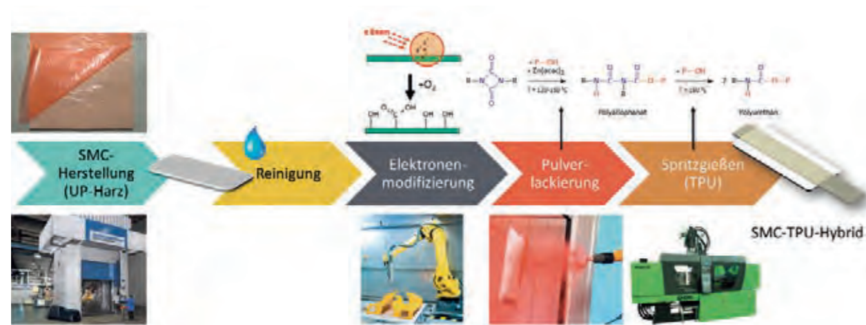
Abb. 1 Effiziente Prozesskette zur Herstellung von stoffschlüssigen FVK-TPU-Hybridstrukturen.
